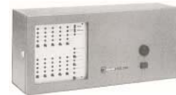
Panel de control Es el mando del sistema de extinción de chispas. Recibe el impulso de alarma de los detectores, procesa las señales disparando el sistema de extinción, pone en marcha las señales de alarma y si se desea puede cortar la energía a los elementos de producción y actuar los de seguridad de la planta.
